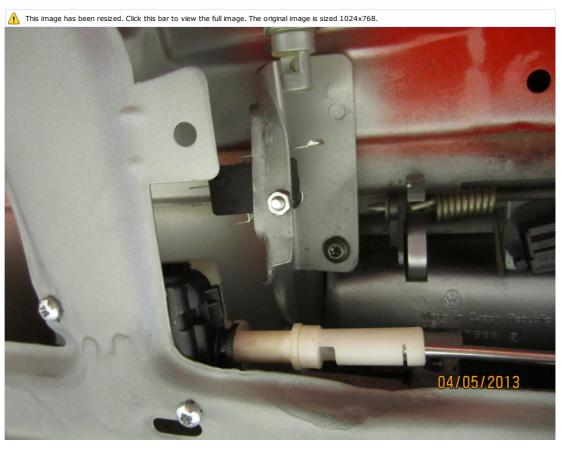
Auf diesem bild sind Microschalter, Griff und Stellmotor verbaut, hier ist das Fahrzeug verriegelt, der Microschalter ist nicht betätigt und somit ist die Anlage Stromlos.
