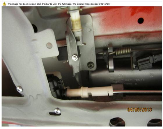
Hier ist das Fahrzeug entriegelt, der Microschalter wird grade eben vom ZV antrieb berührt also mit bedacht festmachen damit da nicht zuviel kraft drauf ist! Nur der Kontakt vom Microschalter sollte bewegt werden.
